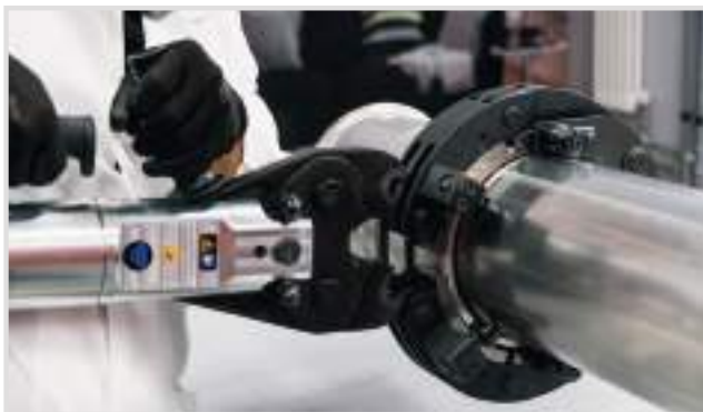
Assemblaggio pressatura n°1 / Press assembly phase 1
